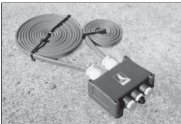
**Trubkové doprovodné topení** sestává z rozdělovacího modulu se dvěma ohebnými topnými pásy, které se pokládají podél potrubí. Topný pás je samoregulující, tj. topný výkon se přizpůsobuje skutečné teplotě. Lze jej libovolně krátit, aniž by se měnil jeho topný výkon na metr.
